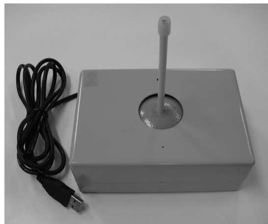
รูปที่ ๘ เครื่องช่วยที่ออกแบบและพัฒนา สำหรับให้คนพิการใช้ปากโยกและเป่า/ดูดในการควบคุม
