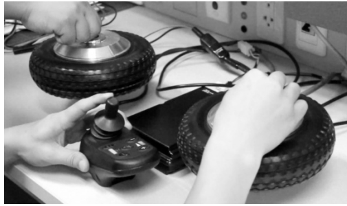
ภาพที่ ๖ แสดงการทดลองทิศทางการหมุนของ HUBMotor ด้วยก้านควบคุม
