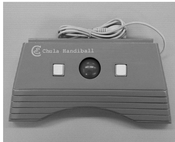
รูปที่ ๔ เครื่องช่วยที่ออกแบบและพัฒนา สำหรับให้คน พิการใช้เท่าในการควบคุม
