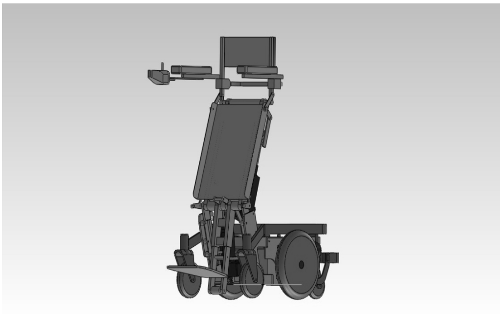
ภาพที่ ๒ โครงสร้างจำลองรถเข็นผู้ป่วยไฟฟ้าแบบปรับยืนได้ในตำแหน่งยืน
