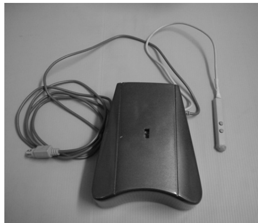
รูปที่ ๘ เครื่องช่วยที่ออกแบบและพัฒนา สำหรับให้คนพิการใช้ปากโยกและเป่า/ดูดในการควบคุม
