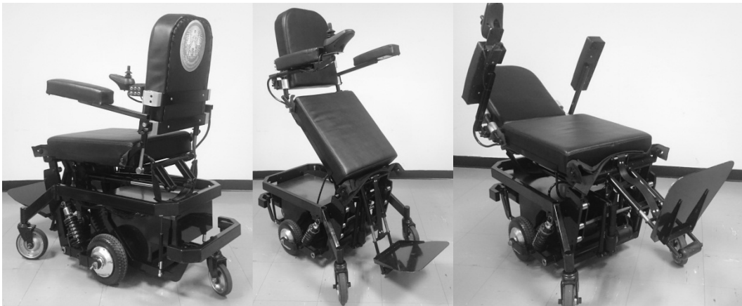
ภาพที่ ๗ ภาพถ่ายรถวีลแชร์ไฟฟ้าต้นแบบขณะทำนั่ง ยืน และนอน ตามลำดับ
