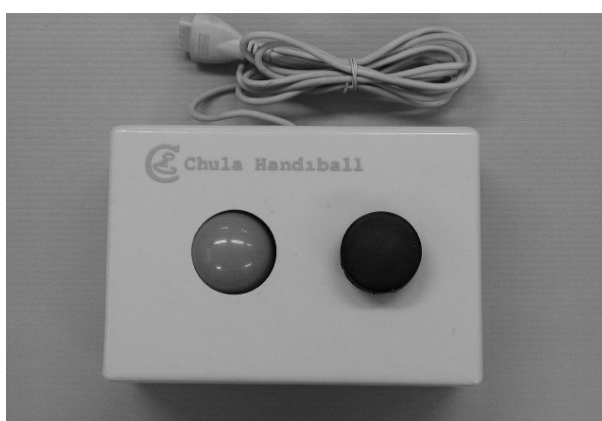
รูปที่ ๑ เครื่องช่วยที่พัฒนาขึ้นครั้งแรกในปี พ.ศ. ๒๕๔๒ สำหรับให้คนพิการใช้คางในการควบคุม
