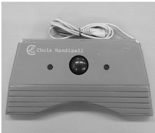
รูปที่ ๗ เครื่องช่วยที่ออกแบบและพัฒนา สำหรับให้คนพิการใช้คางและปากเป่า/ดูดในการควบคุม
