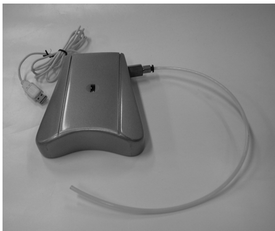
รูปที่ ๗ เครื่องช่วยที่ออกแบบและพัฒนา สำหรับให้คนพิการใช้คางและปากเป่า/ดูดในการควบคุม
